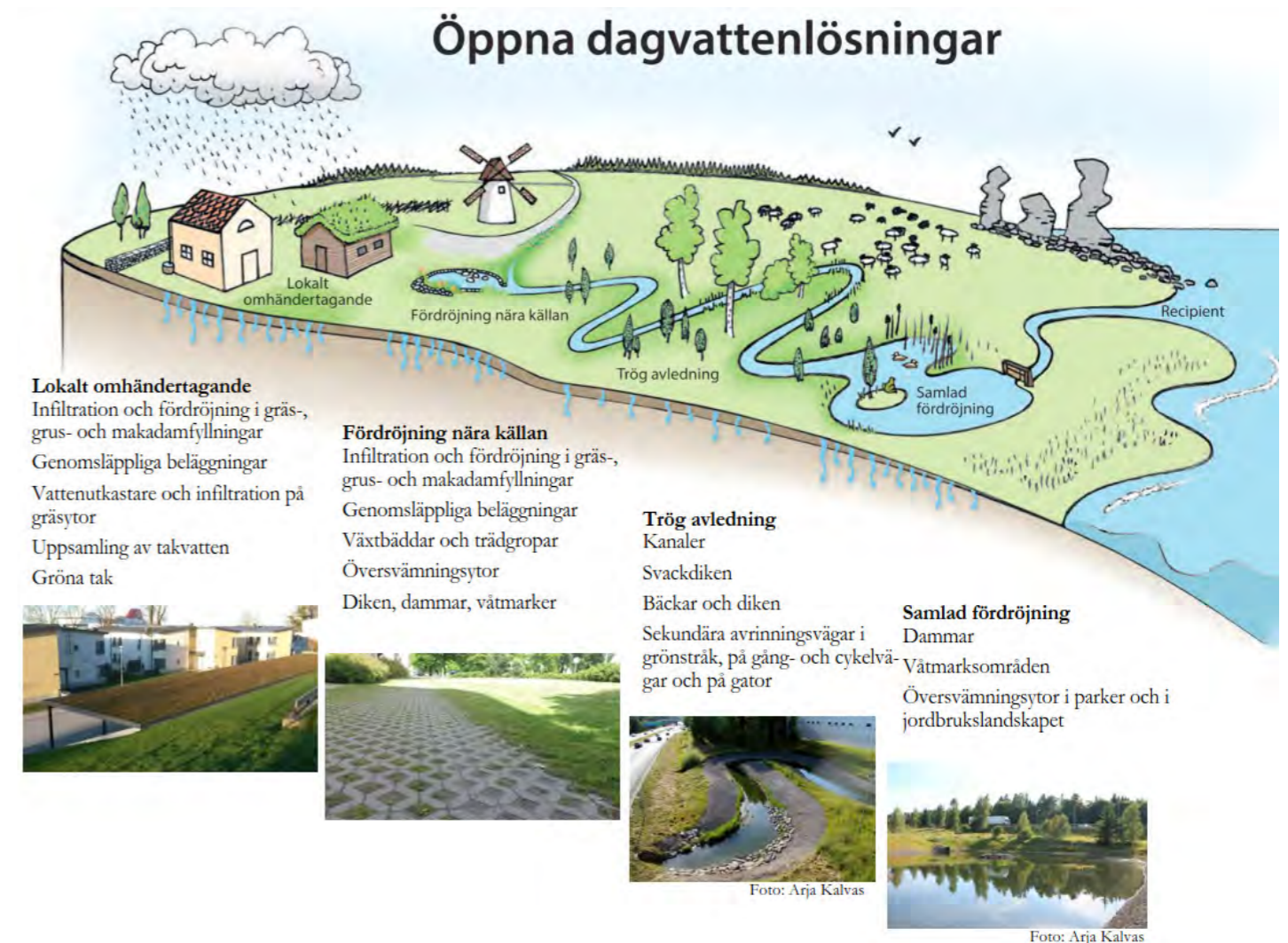
Figur 2: Illustration som visar olika kategorier av öppna dagvattenlösningar längs dagvattnets väg från källan till recipienten. Som grundläggande princip ska vattnet återföras till det naturliga kretsloppet så tidigt som möjligt.
