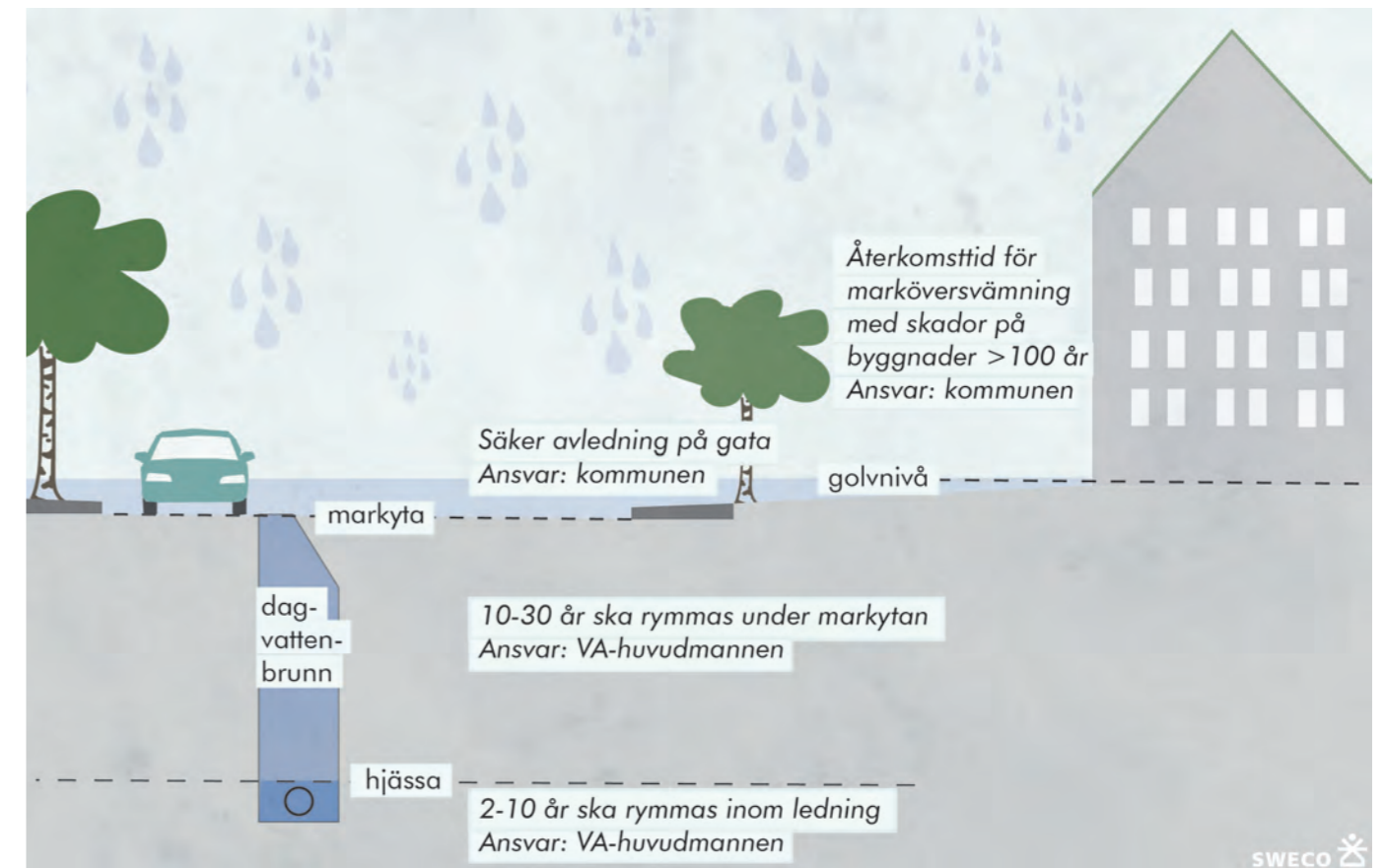
Figur 6: Illustration över höjdsättning och ansvarsfördelning gällande dagvatten utifrån Svenskt vattens publikation P110.
